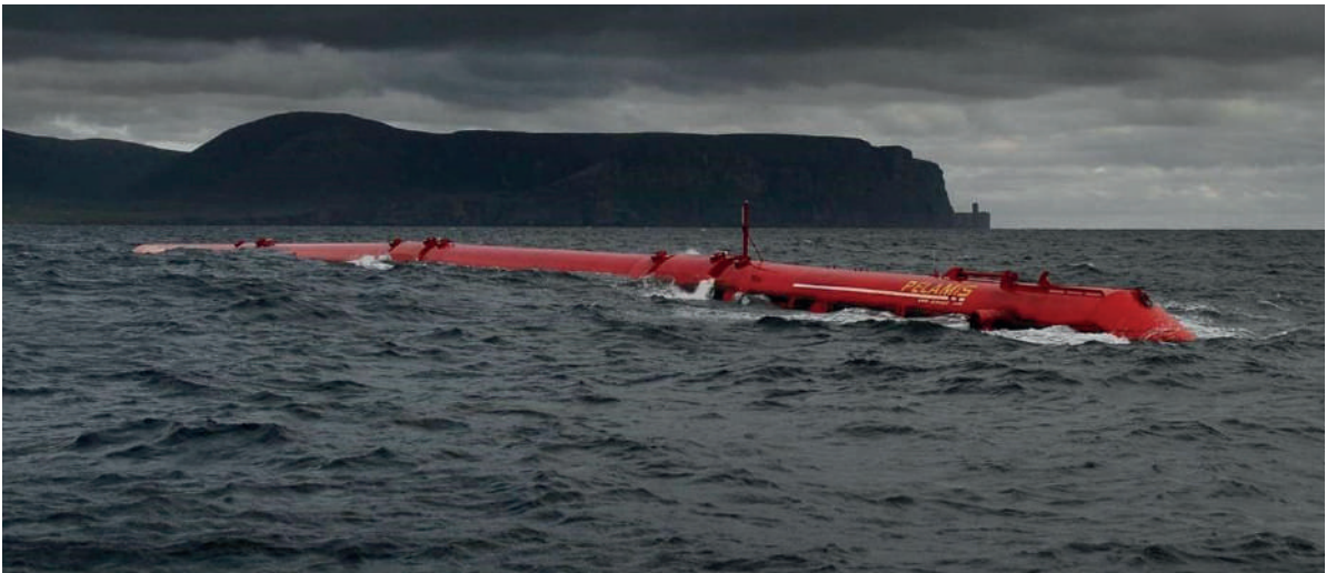
Figura 2 - Conversor de energia das ondas PELAMIS, em teste na Escócia. https://commons.wikimedia.org/w/index.php?curid=4859717
