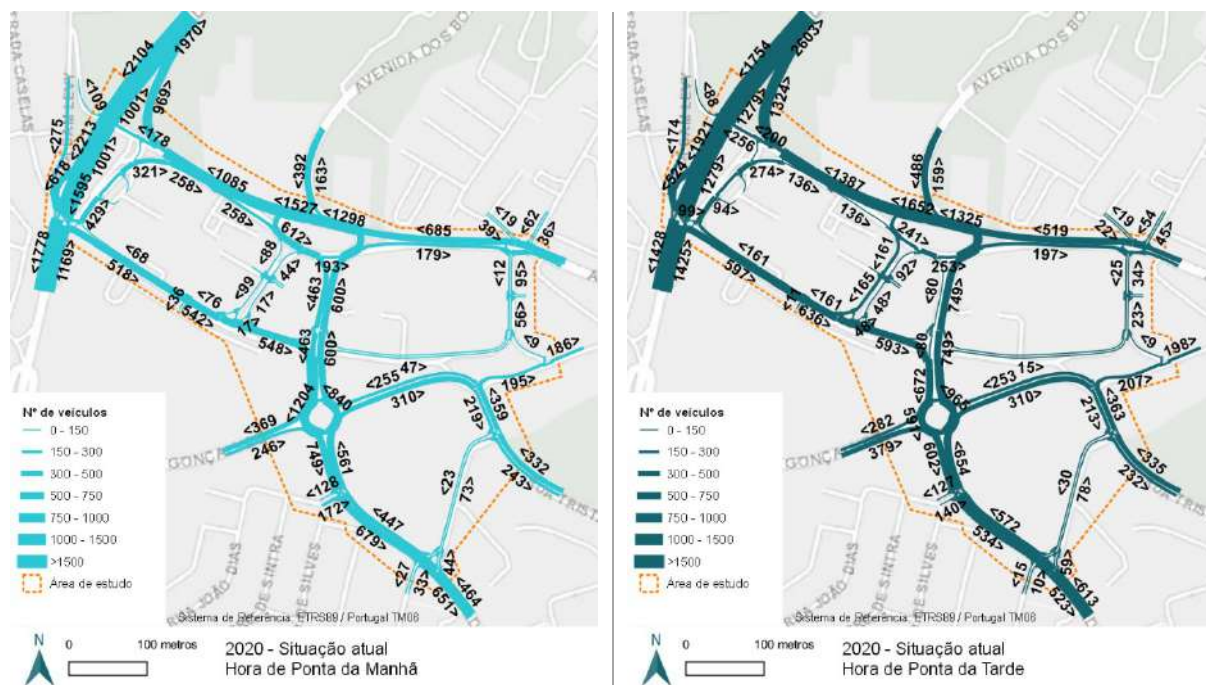
Figura 4.7 – Diagramas de carga totais na situação atual (2020)
