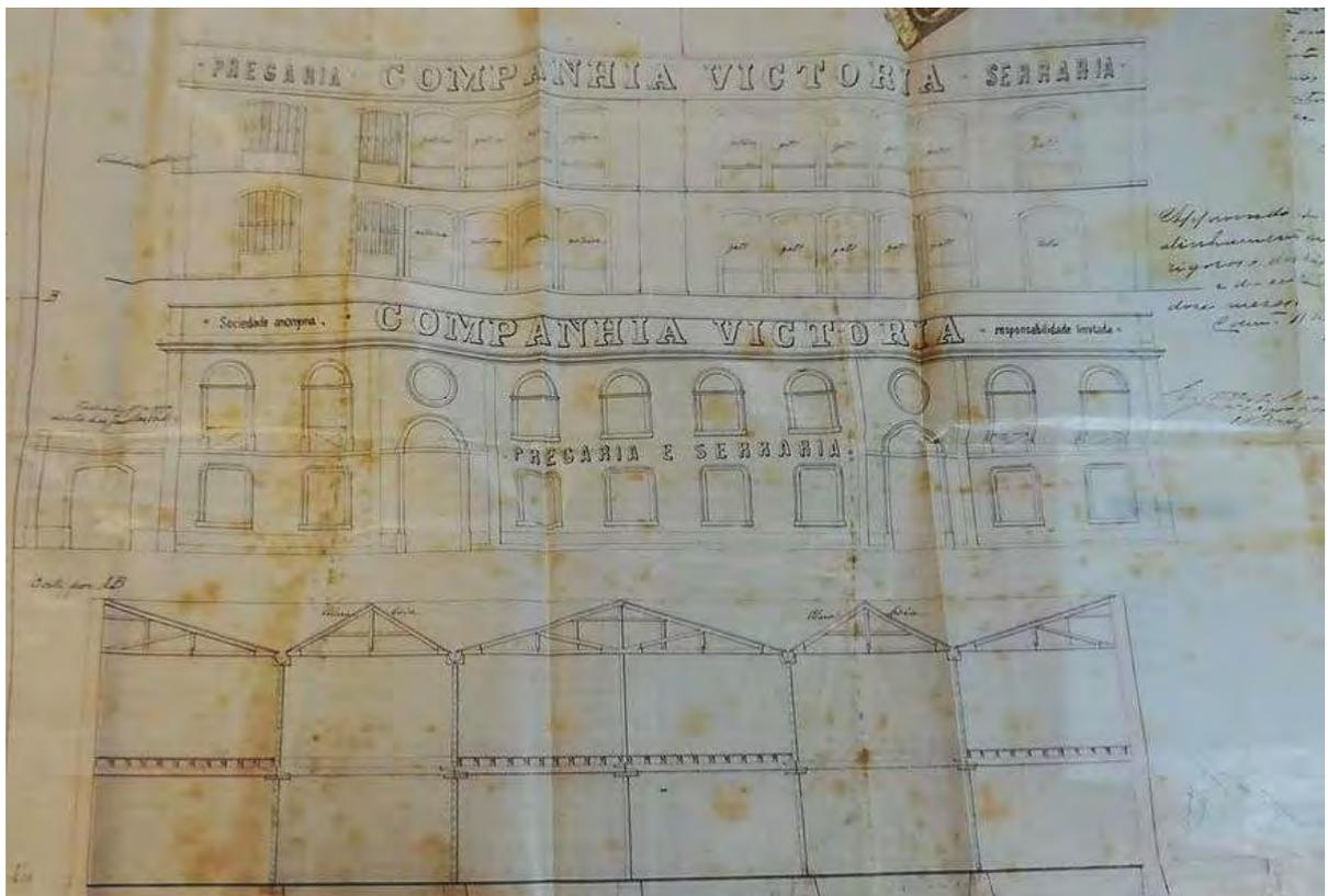
Fig. 8 – Alçados tardoz e principal e corte do projecto do edifício industrial para instalação da Pregaria e Serraria de madeiras Vitória (AML – NI: Obra 16196, Proc, 58/1882, p. 3)
